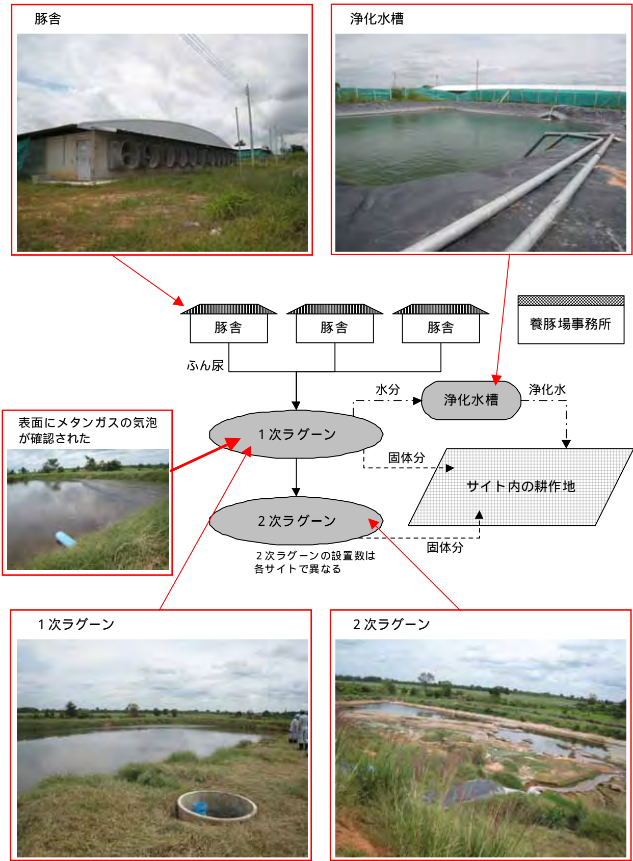
図 1.3.1 対象サイトとした養豚場における豚ふん尿の処理方式の概要
