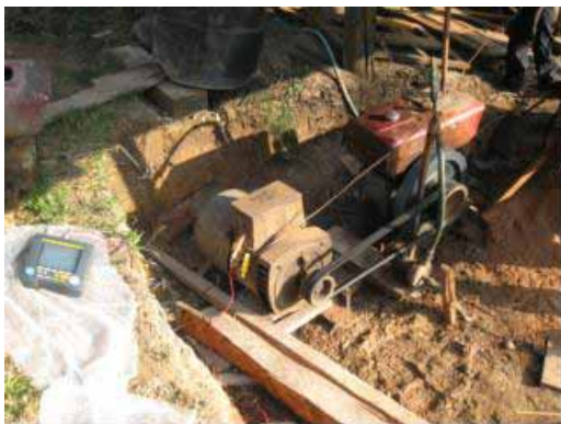
写真 2-1-9 耕運機エンジンでの発電
