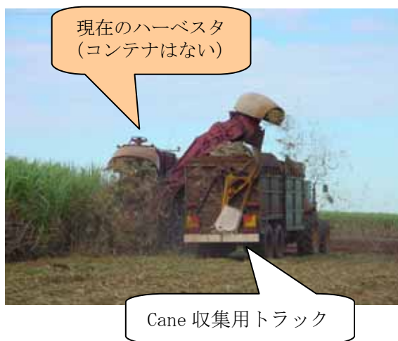
写真 1 現在のハーベスタによる Cane 収穫方法
