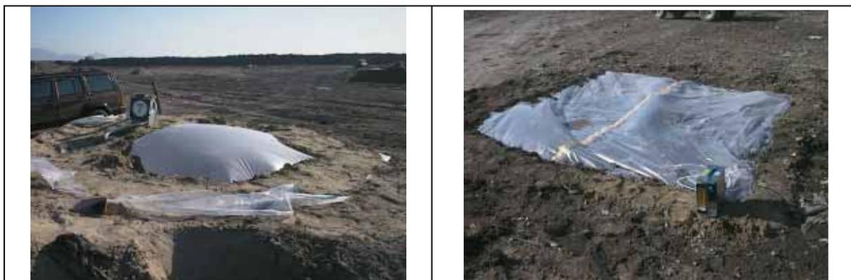
写真3-1 ガス収集井からのガス量測定
