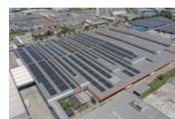
No.7 トヨタ自動車(株) 車両・エンジン工場への37MW太陽光発電システム及び高効率溶解炉の導入
