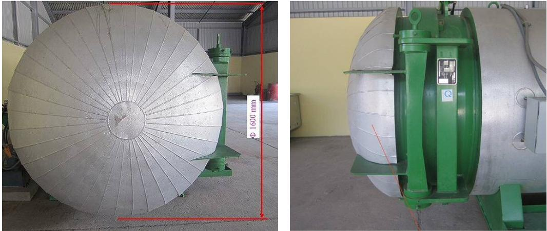
オートクレーブ釜  $\phi=1600$ , 開閉装置
