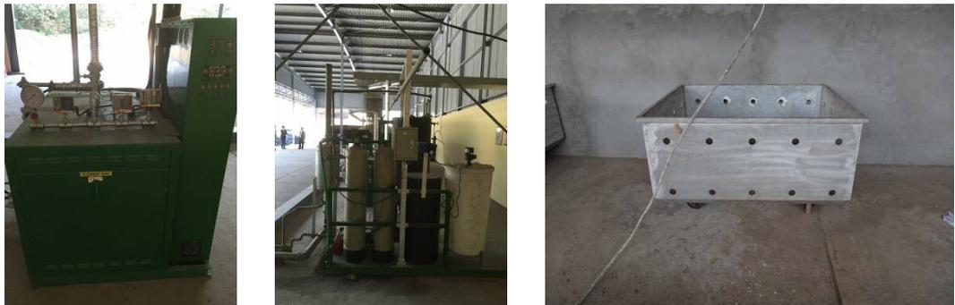
左: 電気式ボイラー510kW、中: 給水装置、右: 廃棄物投入台車
