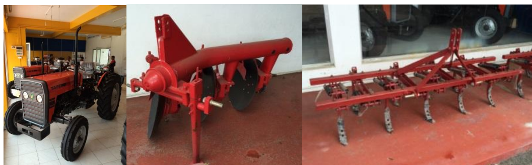
(写真) TAFE 社製・四輪トラクター(左)とトラクター後部に接続する耕耘ユニット(中央・右)
