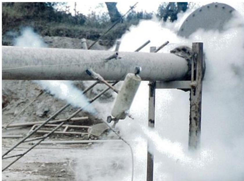
図 4-16 地熱井からの噴出流体採取位置 2 (ミニセパレータ接続状況)
