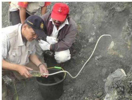
図 4-18 地熱蒸気採取法 2 (真空瓶)
