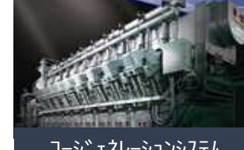
コージェネレーションシステム (豊田通商) ジェネクス ム：川崎重工業製
