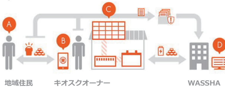
キオスクでの太陽光発電を用いた充電サービス提供システム
