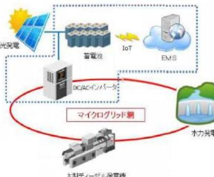
再生可能エネルギーによる発電と蓄電をEMSで制御することにより、自律的に一定時間・一定量の電力安定供給を行う。
