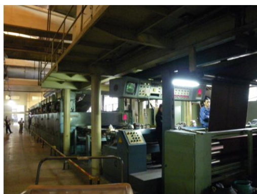
図12 杭州銭江印染化工有限公司 テンター
