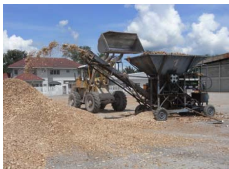
写真 10（参考）キャッサバチップ工場 （クラッシュして天日乾燥するのみ）
