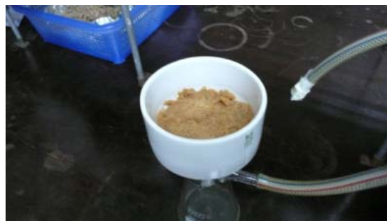
写真 2-1-B カセサート大学における試験 (キャッサバ粕液化・糖化後のろ過試験)
