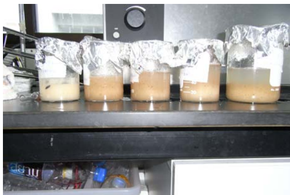
写真 2-1-A カセサート大学における試験 (キャッサバ粕液化・糖化試験)
