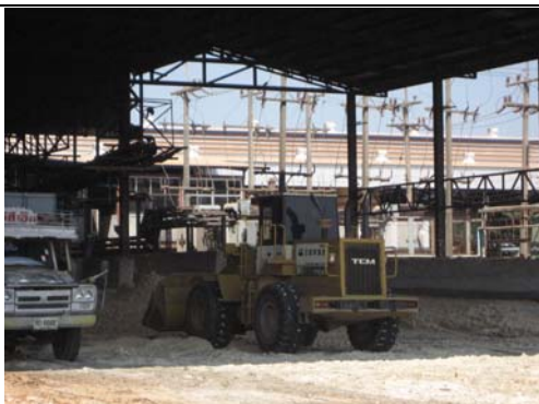
写真5 キャッサバ粕搬出ヤード (コンベアから 落ちてくる粕をトラックで貯留エリアまで搬出)
