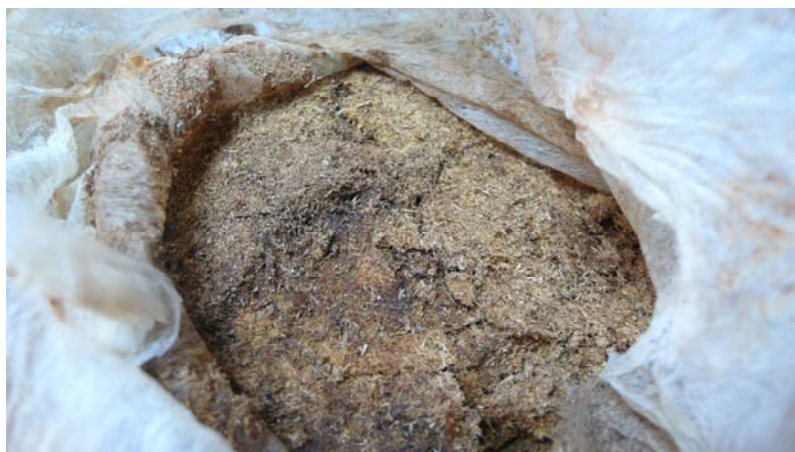
写真 2-7 3ヶ月堆積後のキャッサバパルプ（全体が繊維分の多い乾燥物）
