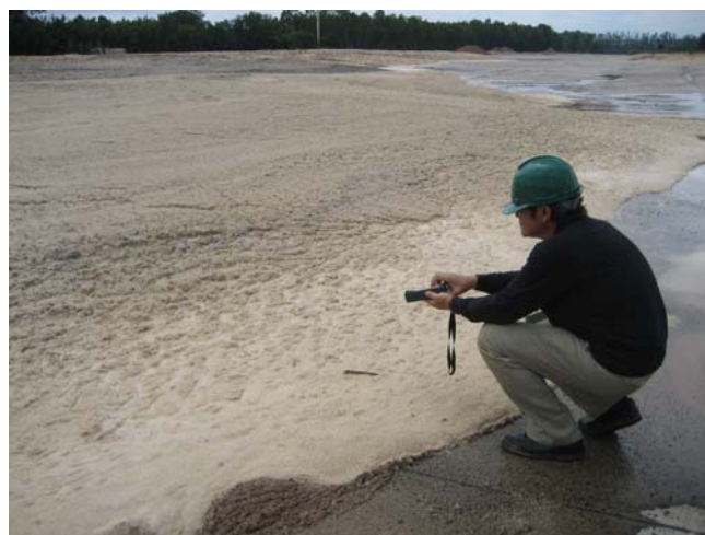
写真 2-5 キャッサバ粕からのメタンガス発生検知
