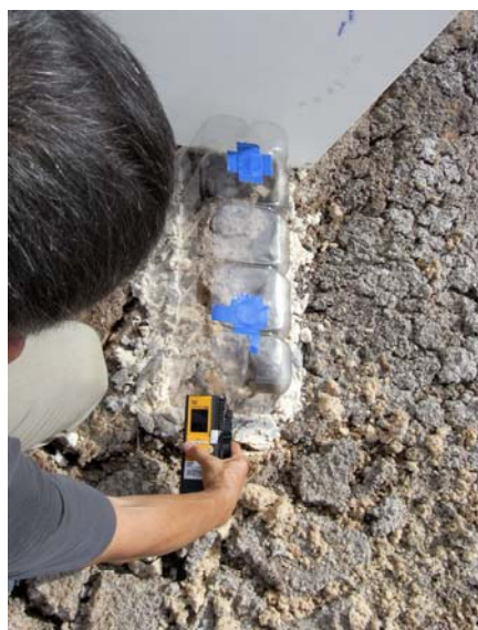
写真 2-4 透明チャンバー内のメタンガス測定
