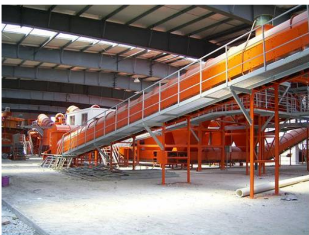
図 2-5 実証試験プラントにおける分別システム(左)および 500kW メタンガス発電ユニット(右)
