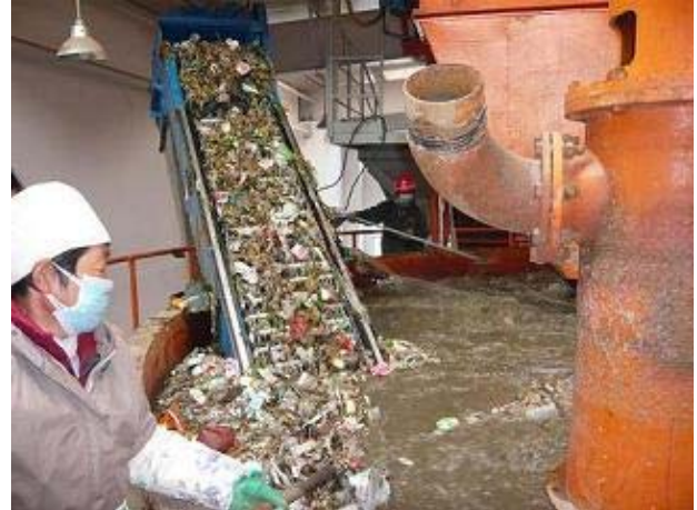
図 2-2 回収された廃棄物（左）および浮力利用による廃棄物の分別風景（右）
