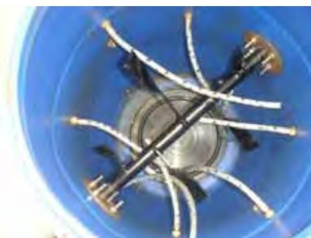
好気試験装置（装置内部のチューブは空気を通すためのもの）
