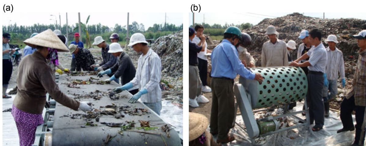
写真 8-2. (a) 手選別と (b) 機械選別によるごみの分別実験
