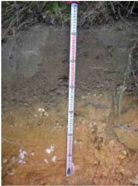
写真 2-1 海岸沿い低地地域の土壌断面。左はB層に粘土質を含む。右は一様に砂質。
