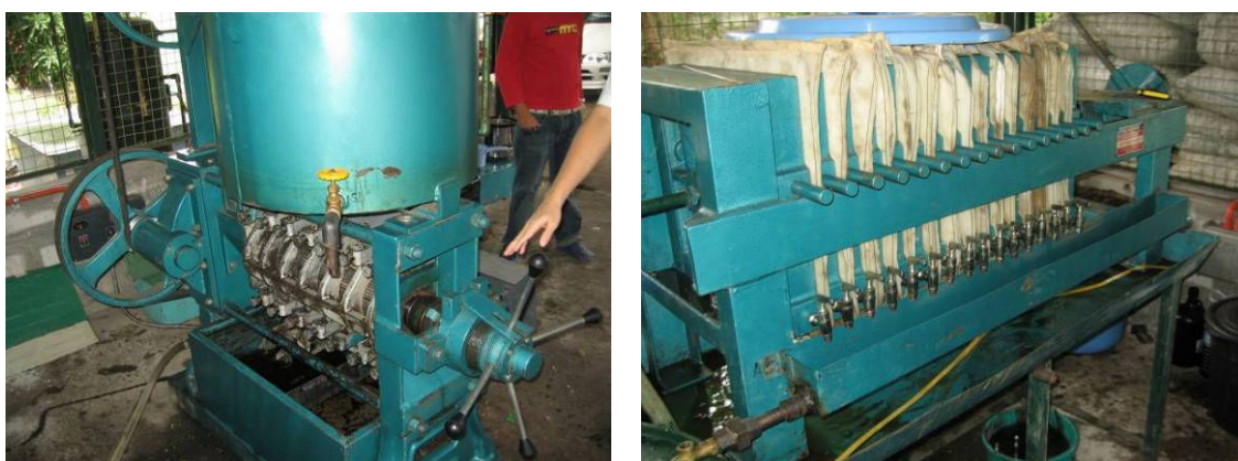
図 1-4 PFC により試験中のフィルター付き搾油機
