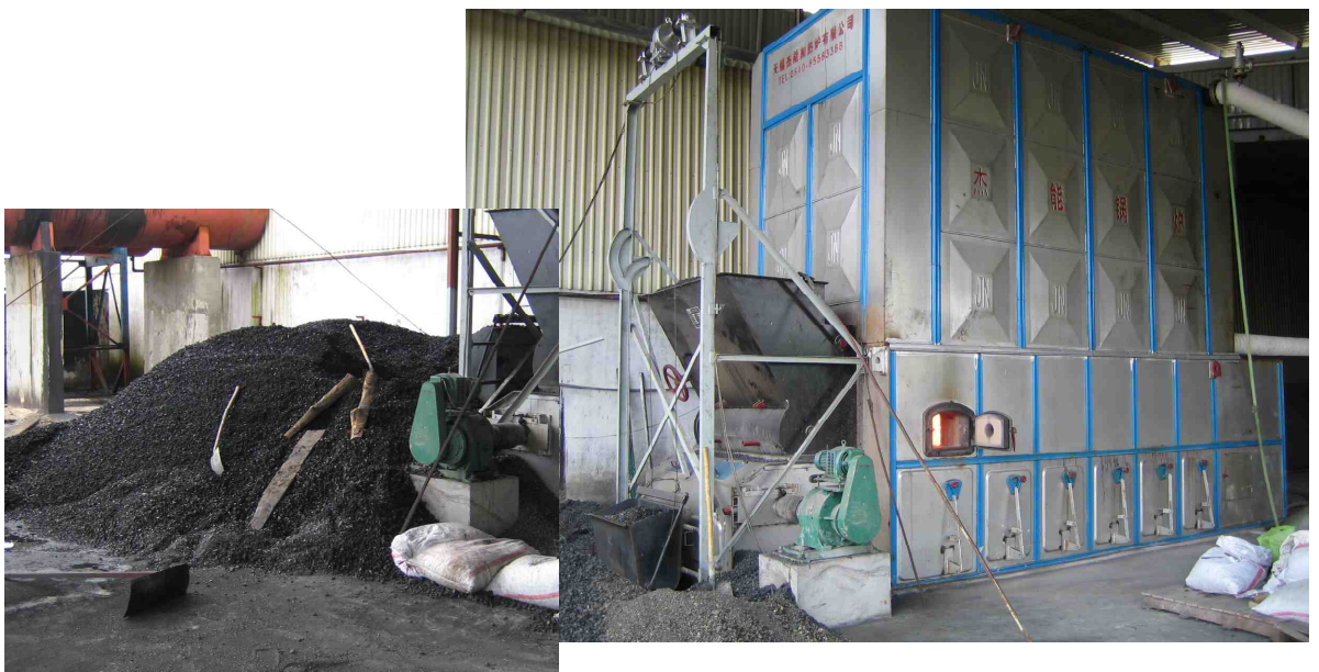
図 2-6 VIETMA 社の石炭加熱炉と燃料の石炭
