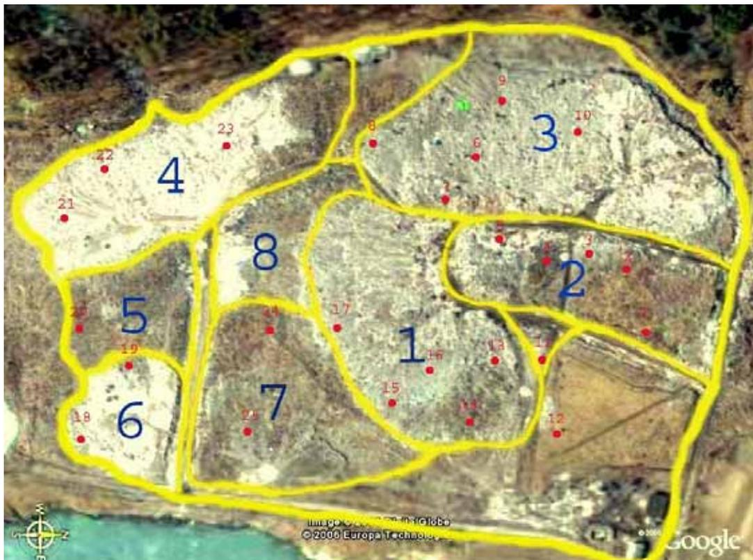
図 8.1-1 試掘調査地点図（赤い点が試掘位置）
