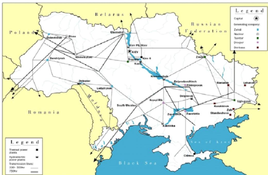
図 1.2-1 ウクライナの発電と送電の系統連系
