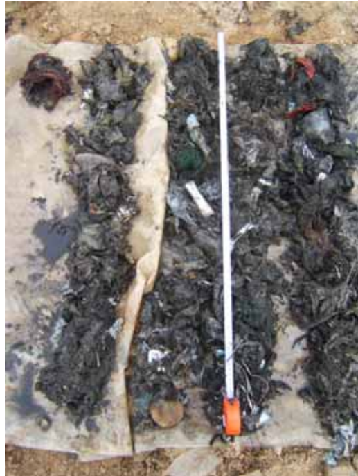
写真 8.2-1(2) B-2 のボーリングコア (一部)
