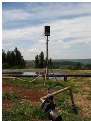
図表 4-18 簡易的なフレアリング装置
