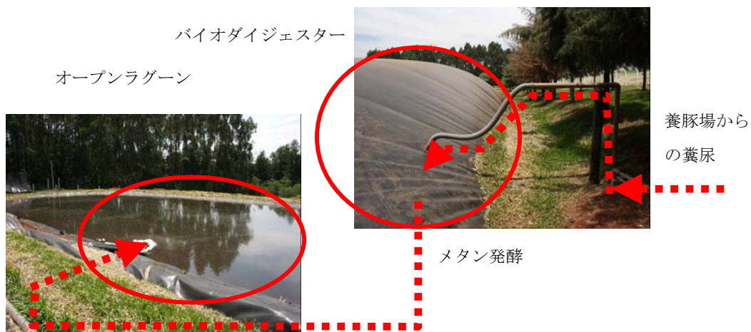
図表 4-16 バイオダイジェスターの仕組み
