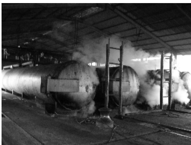
パーム果実熱処理(油の劣化防止のため)
