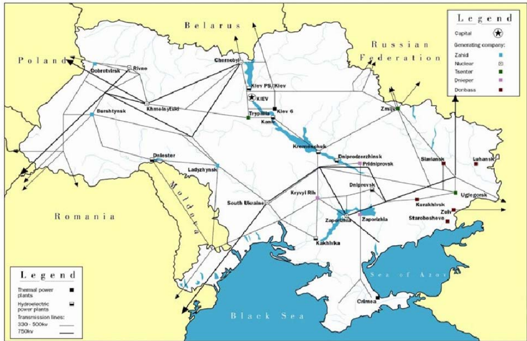
図 1-3 ウクライナの発電と送電の系統連系
