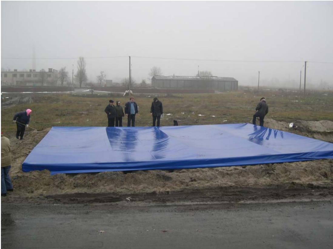
写真-3 試験状況（フラックスチャンバーの設置が完了したところ）
