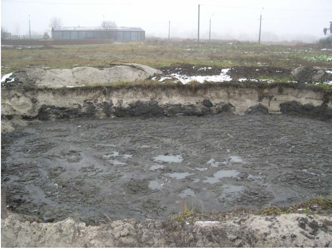
写真-1 試験状況（試験用の汚泥田に汚泥を投入したところ）
