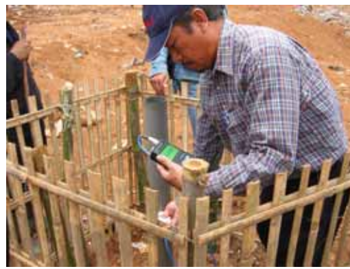
図 6 LFG 流速測定状況
