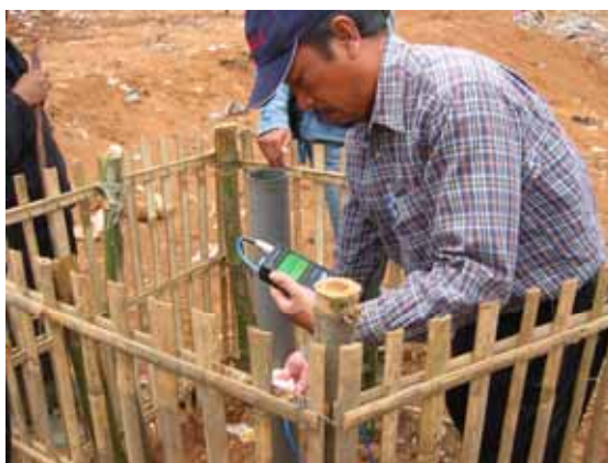
写真 4.11 吐出速度測定状況 3
