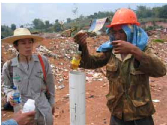
写真 4.22 浸出水のサンプル状況 (No.6)
