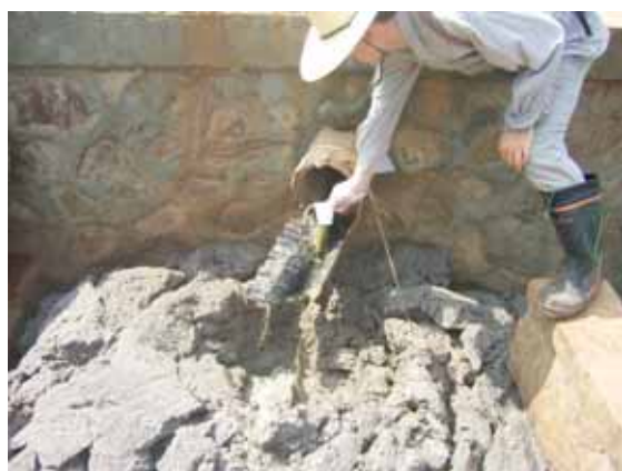
写真 4.14 浸出水のサンプル状況 (No.1)
