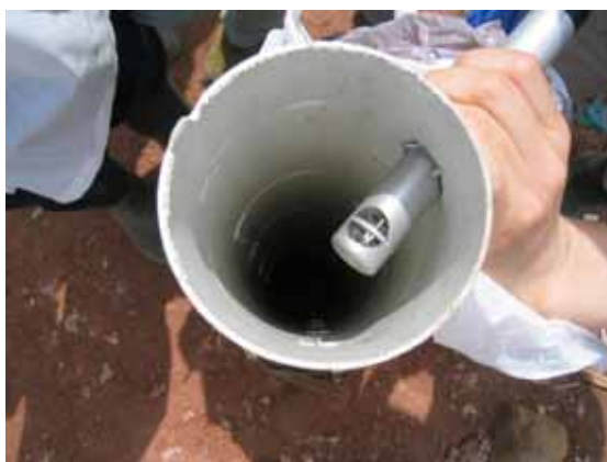
写真 4.9 吐出速度測定状況 1
