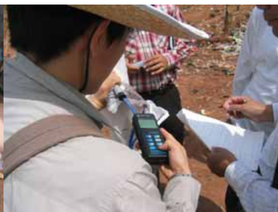
写真 4.10 吐出速度測定状況 2
