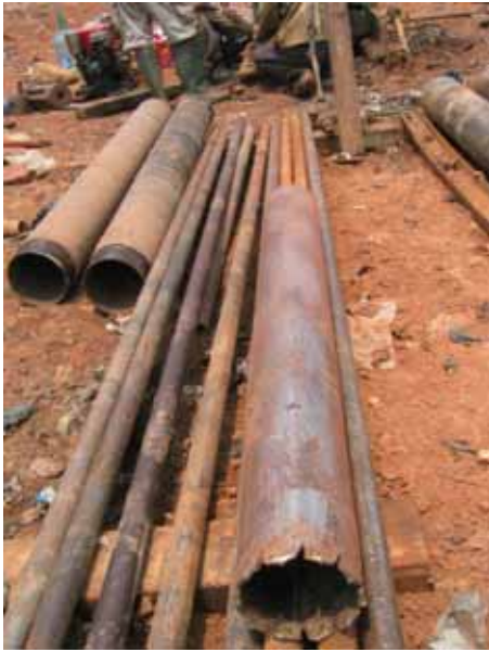
写真 4.3 ボーリングヘッドとケーシング
