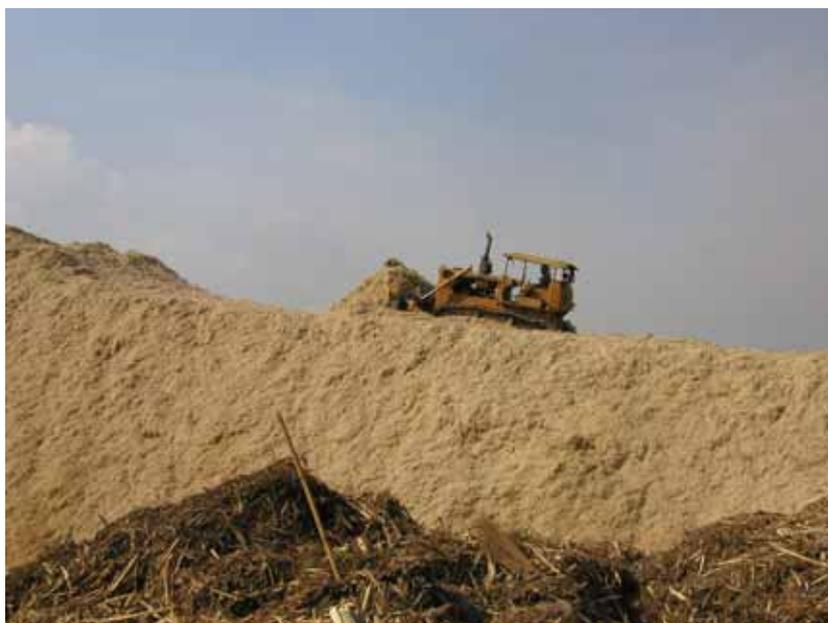
図 3.2-2 野積みされたバガスを整地するブルドーザ
