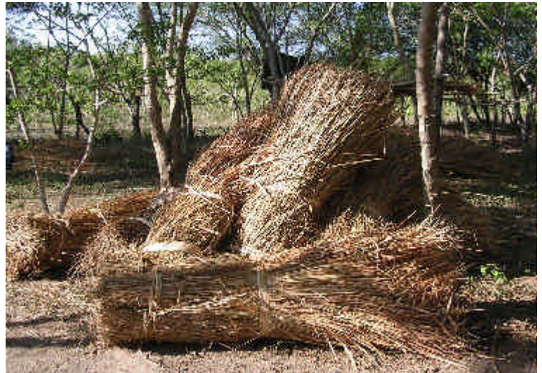
写真15 屋根の材料として利用される アランアラン(JIFPRO)
