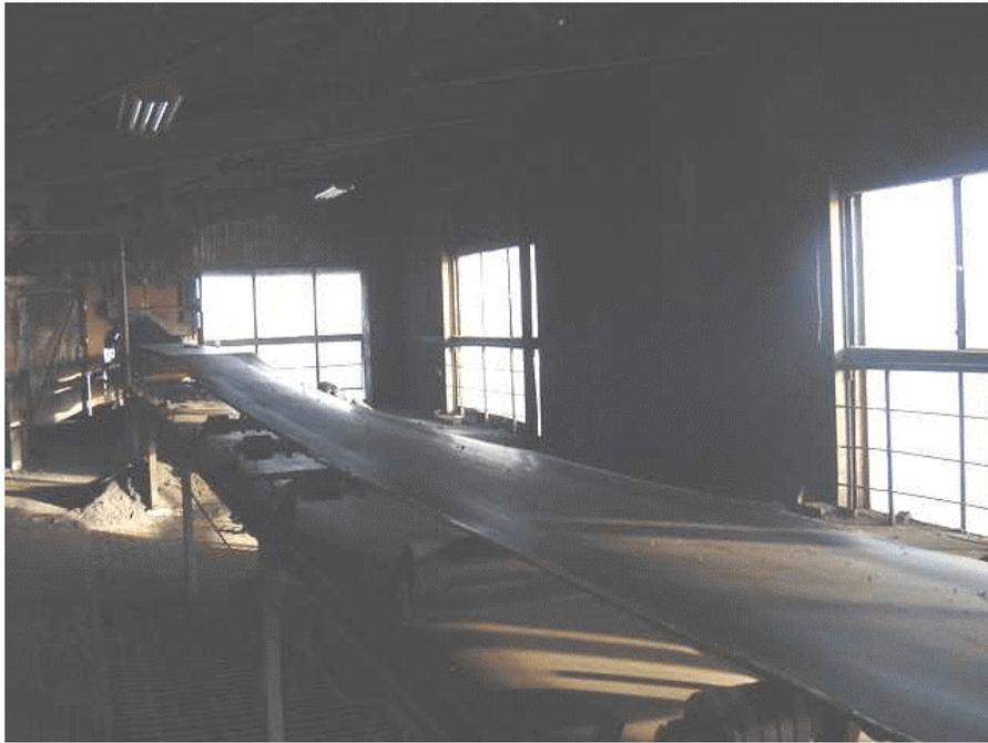
写真 7 ボイラ建屋内石炭輸送コンベヤ
