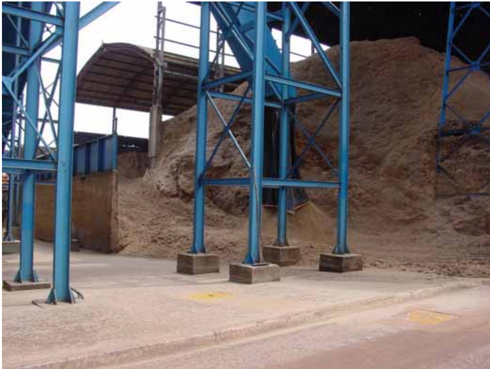
Bioenergia 社バガス一時貯蔵所 中：バガス吐き口、左奥ローラーへの搬入口
