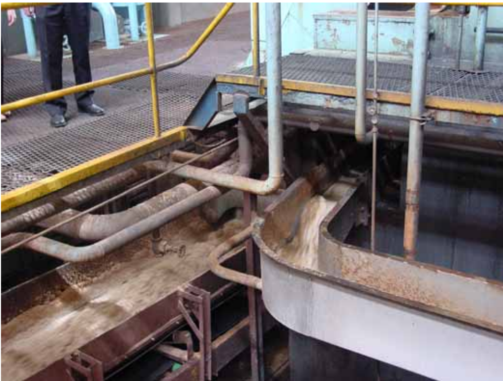
Rosario 社サトウキビ圧搾設備 左下：バガス、右下：絞り汁（糖液）
