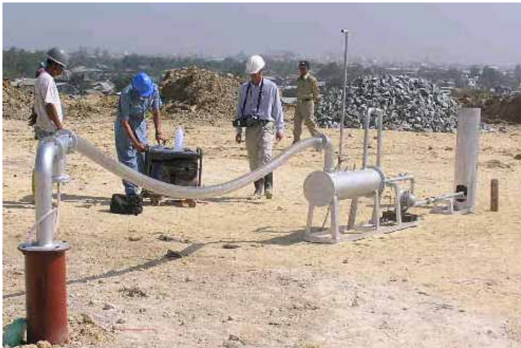
図 3.11 燃焼実験設備
