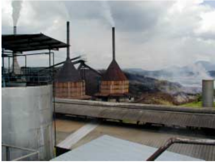
空果房（ Empty Fruit Bunch ）及び殻の焼却炉の現状
