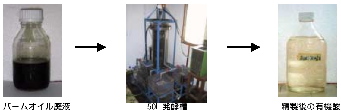
図5-4 パームオイル廃液の連続嫌気処理と単蒸留による有機酸の精製
