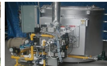
高性能工業炉（リジエ バーナ）（豊通マシナリー）
