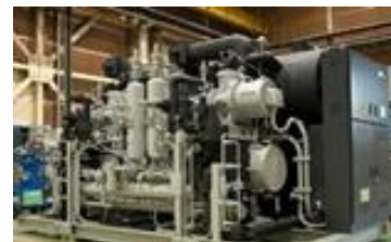
高効率冷凍機 (前川製作所)
