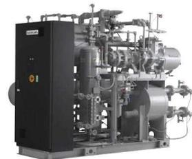
本プロジェクトは、アンモニア冷媒を使ってCO<sub>2</sub>冷媒を冷却し、そのCO<sub>2</sub>を庫内のクーラーに搬送する「間接冷却方式」を採用。これにより、アンモニア冷媒を冷凍装置のみに閉じ込め、冷凍・冷蔵倉庫側の庫内にあるクーラーには冷却されたCO<sub>2</sub>冷媒のみが循環し、安全性を確保している。更に、従来のフロン冷却システムと比較し、約20%もの省エネルギーを発揮するシステムである。
