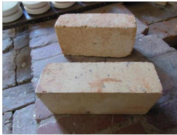
写真 1-1 日本製のカマドサンプル（左）とインド製耐火断熱レンガ（右）
