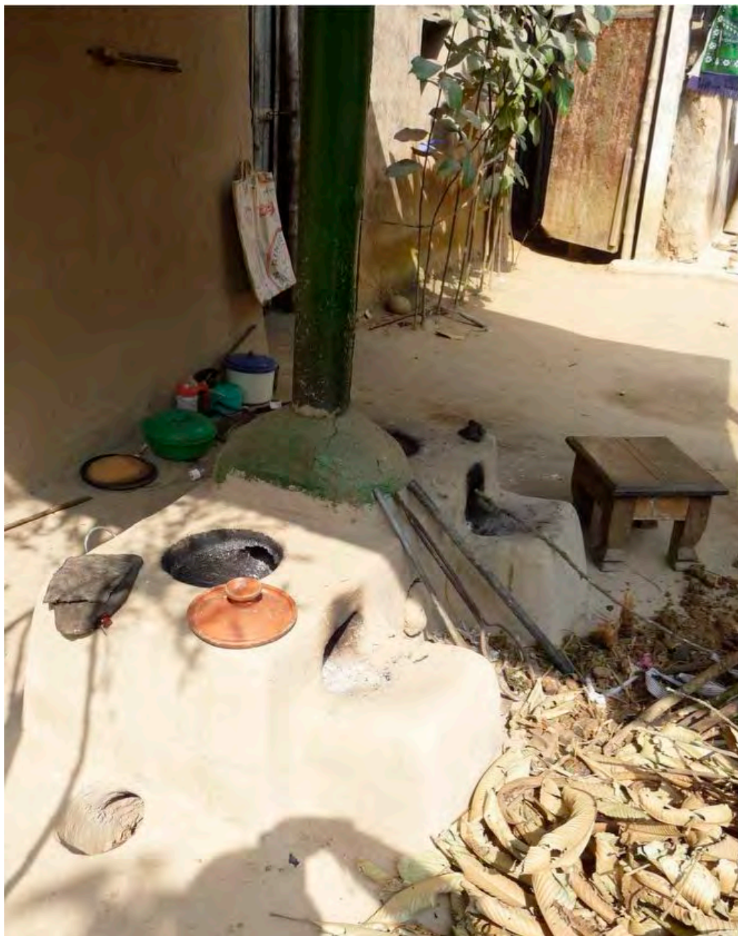
図 1-9: 効率を2倍程度に高めた改良かまど(ICS) これは粘土製
