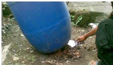
PENGAMBILAN KOMPOS – REAKTOR DIMIRINGKAN DIAMBIL DARI BAGIAN BAWAH
